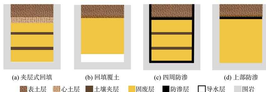
图 3 回填修复原理剖面示意图
