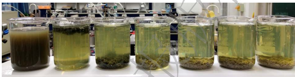
图 4 絮凝效果图(从左到右 PRT 投加量依次为絮凝前、0、1、2、3、4 和 5 g)
