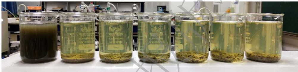
图3 絮凝效果图(从左到右C-PAM投加量依次为絮凝前、2、3、4、5、6、7 mL)
