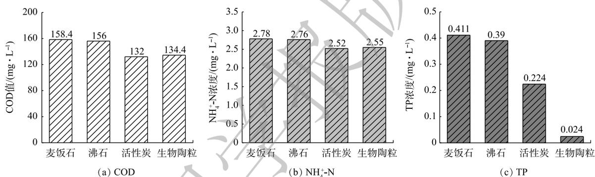
图2 填料吸附后溶液中污染物含量
