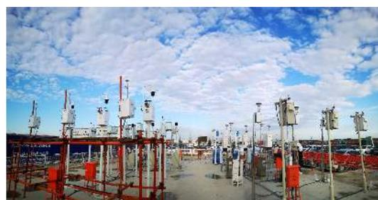
图 1 施工扬尘 PM<sub>10</sub> 监测仪参比方法比对测试场地
